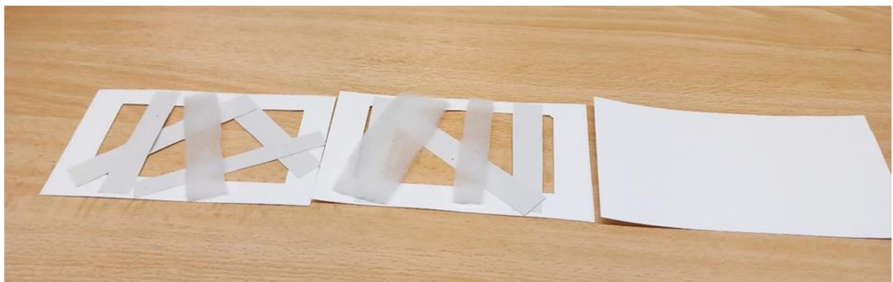
Παραδείγματα φίλτρων που χρησιμοποιούνται στη συσκευή δοκιμής φίλτρου.
